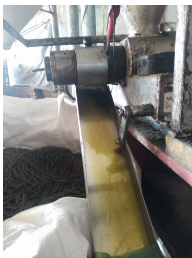
Une installation de la presse sous le silo avec le big bag de tourteau et le fût d'huile
