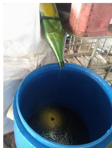
L'huile sort dans la goulotte et va dans le fût
